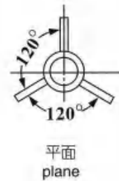
管底定位装置(本厂提供) Bottom fixing
