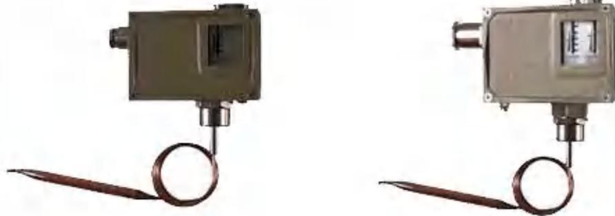
控制器采用带毛细管温包式传感器。可用于流 动的中性气体和液体介质，如果介质为腐蚀性，安 装时可选用不锈钢温包保护套套在铜质温包外（见 附件）。控制器的设定植可调，调节范围 - 30……280℃。
